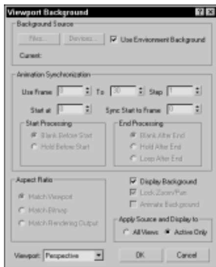
Рис. 8. Фоновое изображение появится в окнах проекции после настройки параметров диалогового окна Viewport Background
