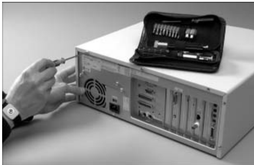
Рис. 1.5. Чтобы снять крышку большинства горизонтальных и вертикальных корпусов, следует выкрутить винты, расположенные вокруг по периметру задней панели. На некоторых компактных горизонтальных корпусах винты находятся сбоку. Будьте внимательны и не выкрутите винты, закрепляющие блок питания внутри корпуса
