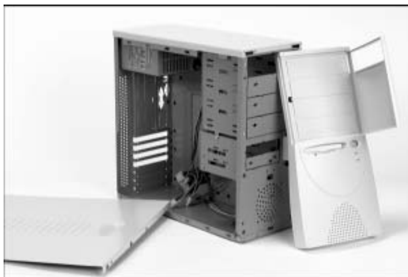
Рис. 1.8. Чтобы открыть боковые панели такого корпуса, сначала снимите переднюю панель
