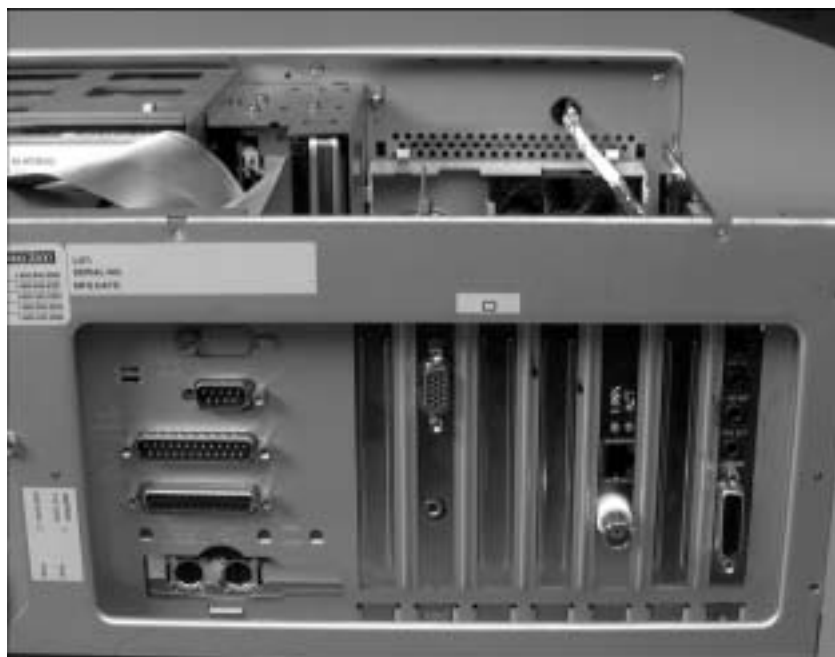
Рис. 1.9. На задней панели системного блока современного компьютера на базе Pentium расположены последовательные, параллельные порты, а также разъемы для подключения монитора, мыши, клавиатуры и сети
