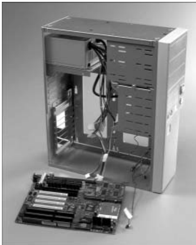
Рис. 1.4. С этого корпуса крышка была снята, чтобы было видно обе стороны внутреннего каркаса. Здесь также показана новая системная плата. Перед установкой в корпус в нее были вставлены электрические и информационные кабели
