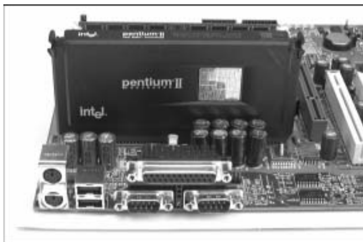
Рис. 1.10. На системной плате форм-фактора ATX расположен блок разъемов. Таким образом убирается большинство кабельных соединений. Чаще всего на системных платах ATX также присутствует пара портов USB (здесь они показаны справа от портов для клавиатуры и мыши)
