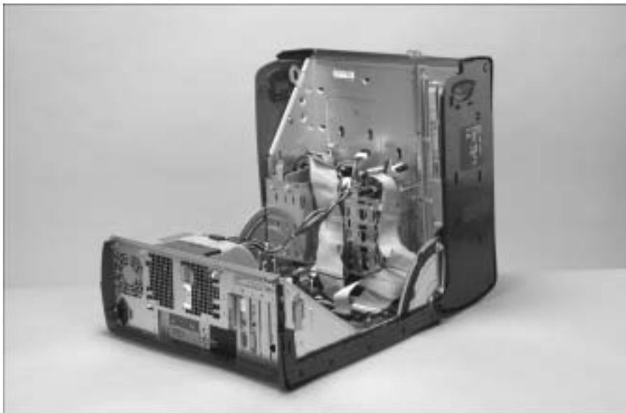
Рис. 1.6. Этот ультрасовременный корпус открывается нажатием двух кнопок. На этой фотографии системная плата находится горизонтально внизу, а отсек с накопителем CD-R, жестким диском и дисководом — в верхней, откидывающейся части корпуса
