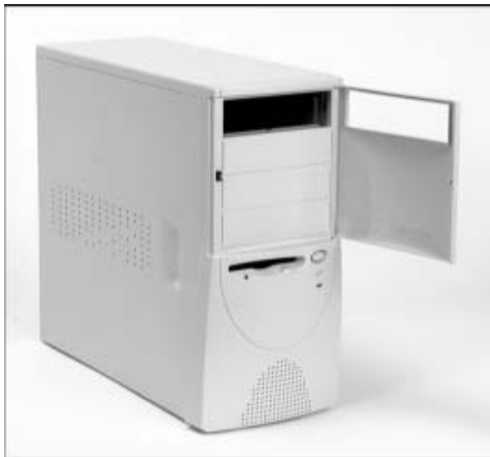
Рис. 1.7. За дверцей на передней панели этого современного корпуса скрываются четыре отсека для устройств. Среди них присутствует специальное отверстие для привода CD-ROM. Если установить еще одно устройство 5.25", например, DVD-ROM или ленточный накопитель для резервного копирования, вам придется снять одну из заглушек
