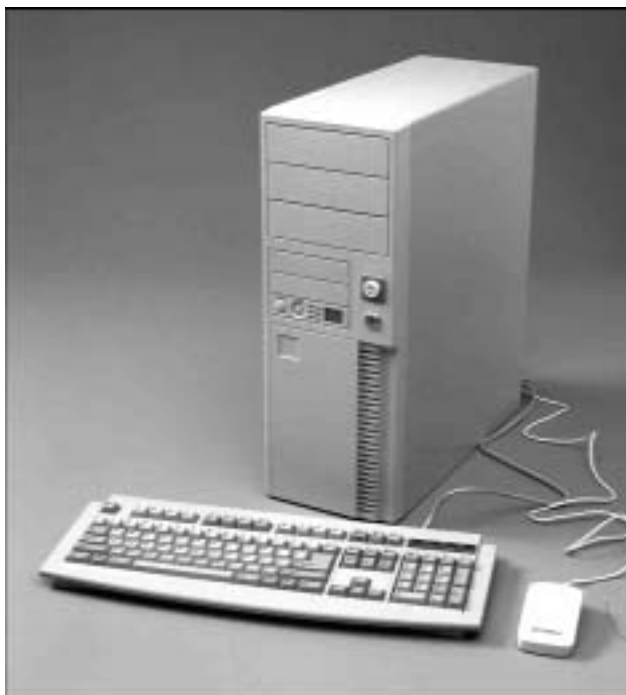
Рис. 1.3. Вертикальные корпуса позволяют легко расширять функциональные возможности системы. В этом корпусе есть пара отсеков для приводов, в которые можно вставить три устройства 5,25" или четыре 3,5"
