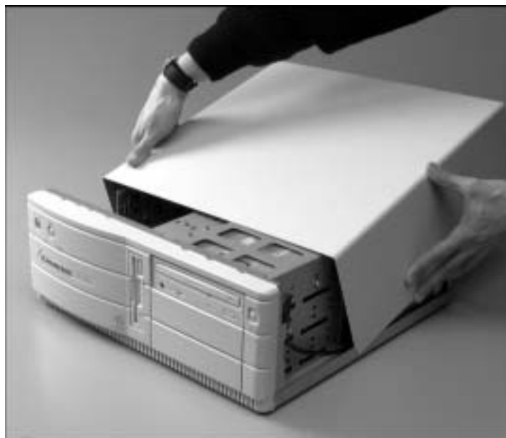
Рис. 1.2. Сдвиньте крышку назад и вверх от переднего края корпуса. В некоторых компьютерах можно найти медный экран, являющийся частью системы защиты от исходящих помех
