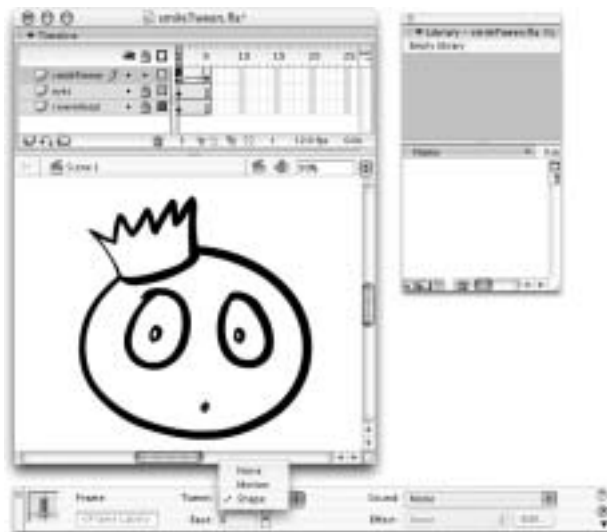
Рис. 11.11. Чтобы применить операцию автоматического заполнения кадров с интерполяцией изменений формы, выберите команду Shape из меню Interpolate (справа от надписи Tween в инспекторе свойств)
