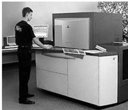
*Рис. 8.15. Цифровая офсетная машина Indigo Press w3200*
