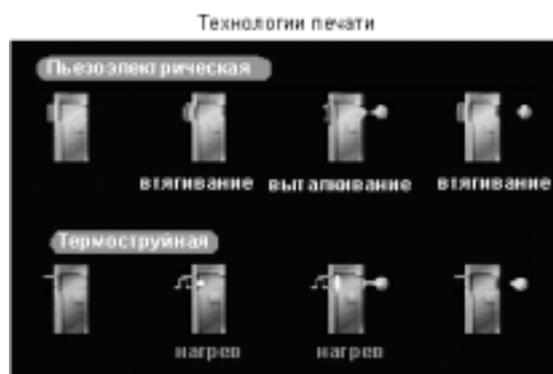
Рис. 8.19. Пьезоэлектрическая и термоструйная технологии струйной печати
