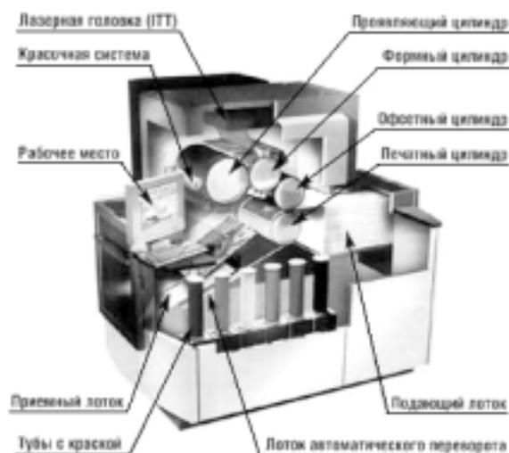
Рис. 8.17. Схема цифровой офсетной машины Indigo Press w3200
