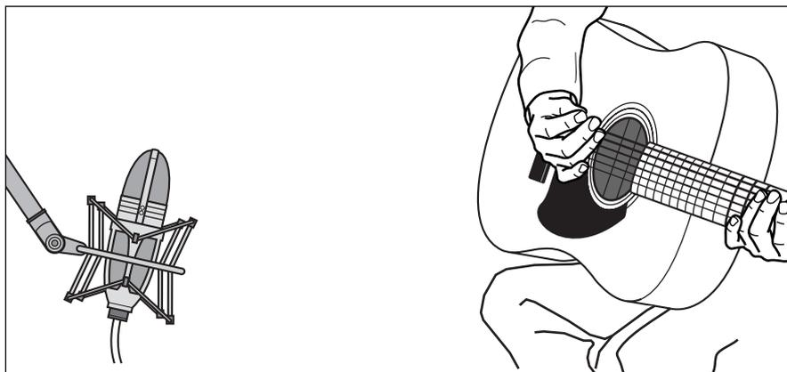
Рис. 8.2. При удаленном расположении микрофон находится на расстоянии около метра от источника звука
