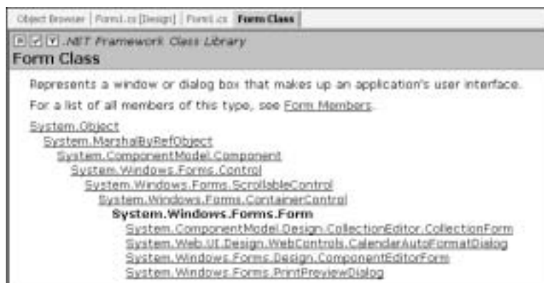
Рис. 6.1. Иерархия наследования для класса Form
