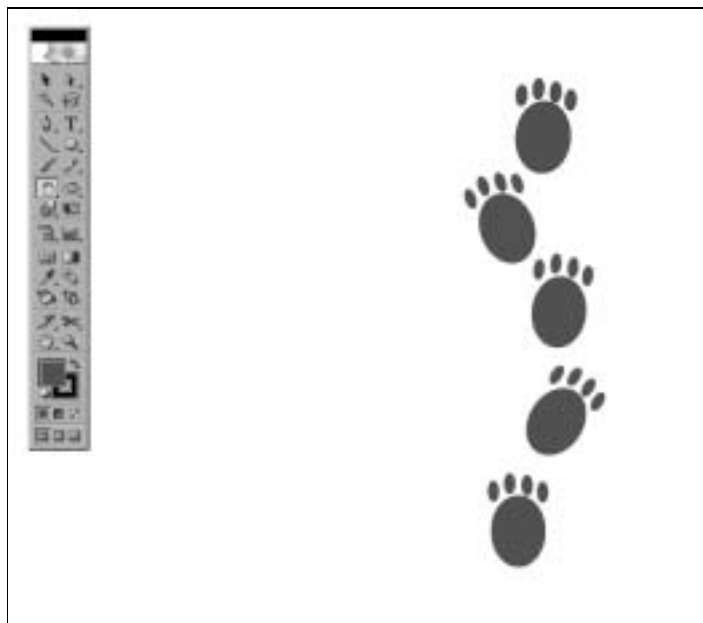
Рис. 11.18. Используя инструмент Rotate и команду Transform Again, можно без каких-либо затруднений расположить копии исходного объекта вдоль дуг правильной формы
