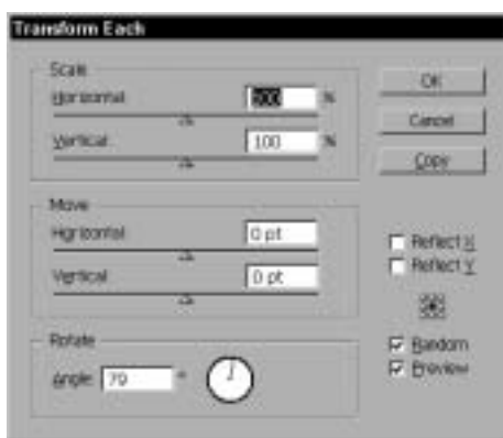
Рис. 11.15. Диалоговое окно Transform Each позволяет одновременно выполнить трансформирование сразу нескольких выделенных объектов
