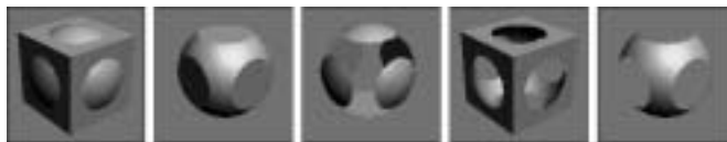
Рис. 18.17. Результаты применения булевых операций (слева направо): Union , Intersection , Subtraction (A-B) , Subtraction (B-A) и Cut (с установленным параметром Remove Inside (Удалить внутренний))
