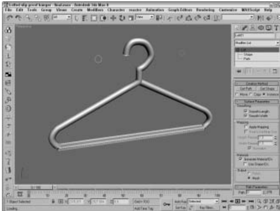
Рис. 18.20. Эта вешалка создана на основе опорных сечений разной формы
