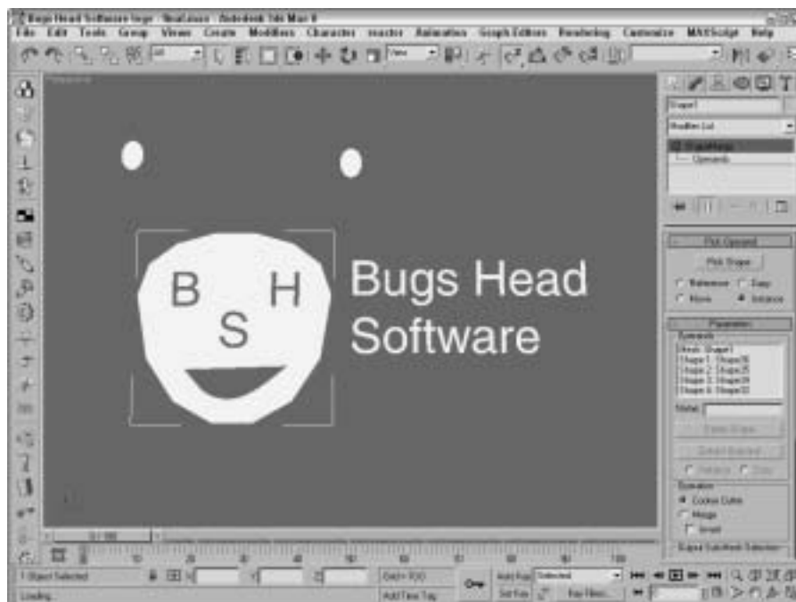
Рис. 18.7. С помощью объекта ShapeMerge внутренние части выдавленных букв исчезли
