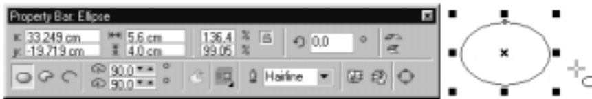
Рис. 4.13. Панель параметров при рисовании эллипса, а также сам эллипс, элементы его выделения и указатель мыши инструмента Ellipse
