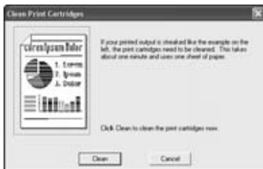
Рис. 4.7. Подготовка к чистке сопел печатающих головок
