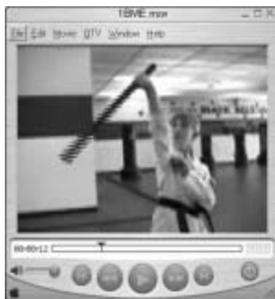
Рис. 3.2. При съемке быстро движущихся объектов камерой, работающей в чересстрочном режиме, могут возникать подобные эффекты
