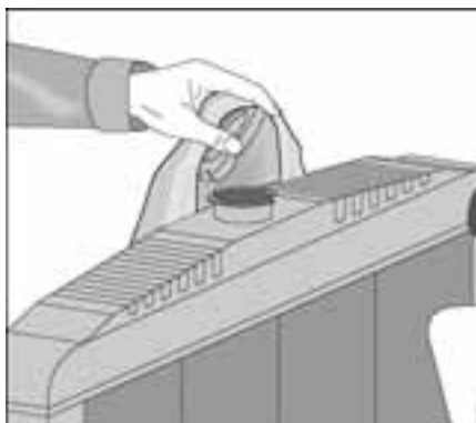
Рис. 3.8. Безопасное снятие крышки радиатора
