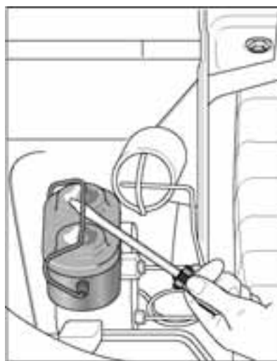
Рис. 3.13. Снятие с помощью отвертки крышки металлического главного цилиндра
