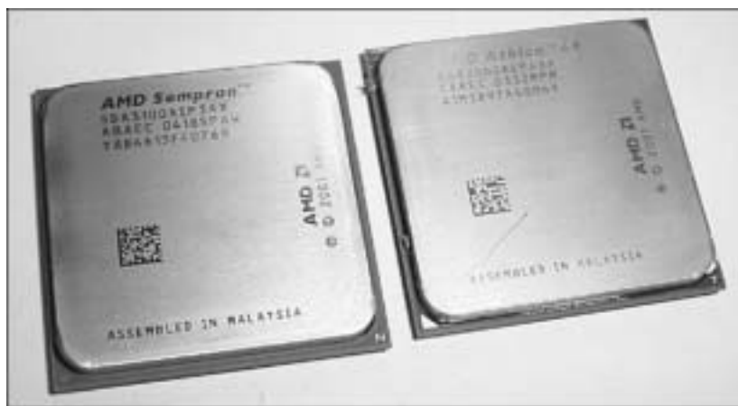
Рис. 3.12. Ядро процессора Sempron 2300+ для гнезда Socket-A. Корпусы процессоров Socket 754 Sempron 2300+ и Sempron 3300+
