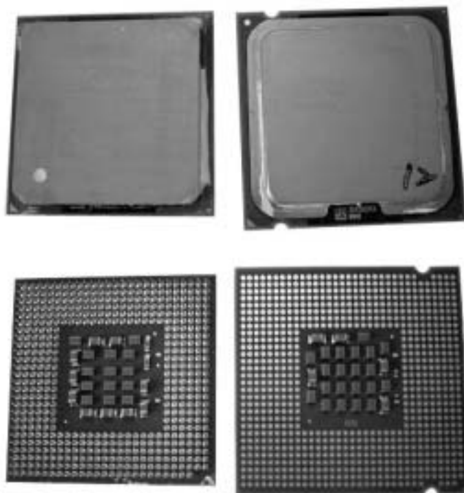
Рис. 3.7. Вид процессорных корпусов FC-PGA 478 и FC-LGA 775 (вид сверху и снизу)
