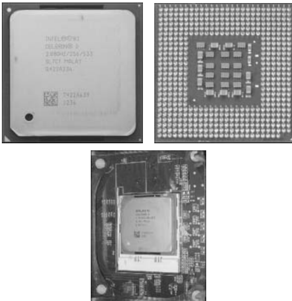
Рис. 3.6. Процессор Celeron Prescott FC-PGA2. Вид сверху, цоколь и размещение в гнезде Socket 478 на системной плате
