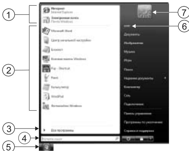
*Рис. 4.14. Меню Пуск: программы для работы с Интернетом и электронной почтой (1); часто используемые программы (2); доступ к установленным программам (3); поле для ввода ключевых слов (4); кнопка Пуск (5); используемая учетная запись (6); изображение, ассоциированное с учетной записью (7)*
