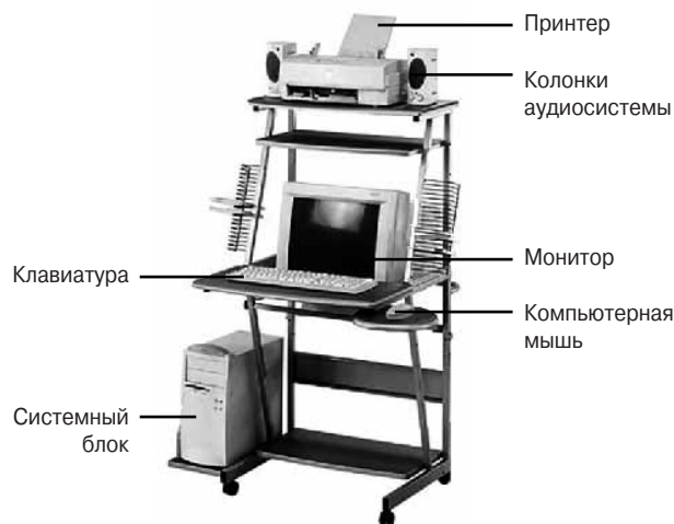
Рис. 1.8. Составные части настольного ПК
