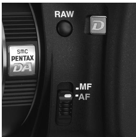
Рис. 3.7. Удобный переключатель, расположенный на оправе объектива или корпусе фотокамеры, позволяет быстро переходить от автоматической к ручной фокусировке и обратно
