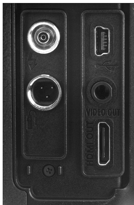
Рис. 3.8. USB-порт (верхнее гнездо справа) и HDMI-порт (нижнее гнездо справа) позволяют подсоединять фотокамеру непосредственно к переносному компьютеру или телевизору высокой четкости соответственно
