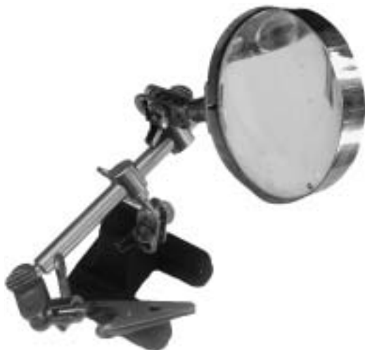
Рис. 3.4. Вспомогательная трубочина совмещает зажим типа “крокодил” и увеличительное стекло
