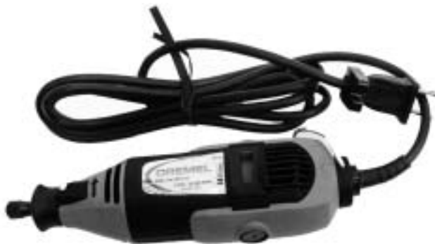
Рис. 3.6. Бор-машинка работает на чрезвычайно высокой скорости; благодаря этому ее можно использовать для сверления, резки и придания формы практически любому материалу
