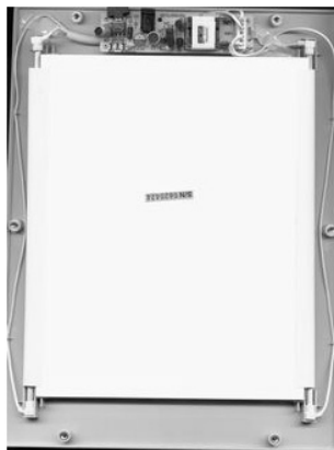
Рис. 1.10. Элементы планшета для сканирования прозрачных образцов
