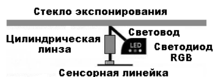
Рис. 1.7. Схема сканера технологии LIDE
