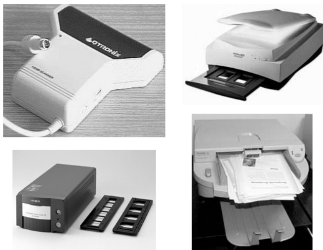
Рис. 1.1. Сканеры для ПК — ручной, планшетный, рулонный и слайд-сканер
