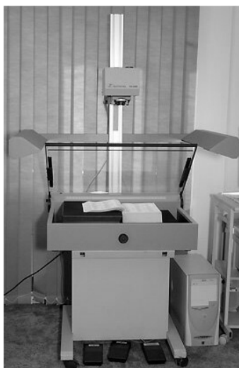
Рис. 1.3. С помощью проекционных сканеров можно сканировать объемные образцы
